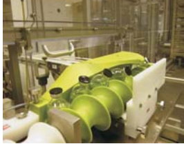
шнековый конвейер из Tecaglaid Green
